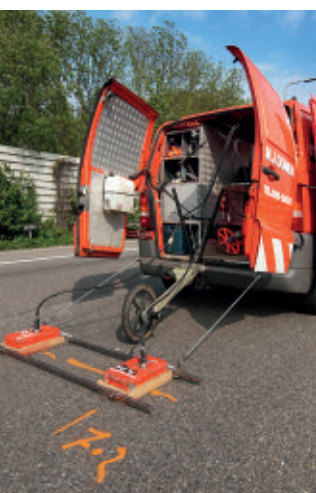
Asfalt laagdikte onderzoek
