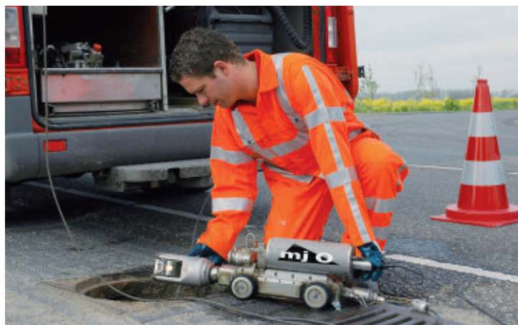
Radarantenne op de 'rug' van de inspectiecamera
